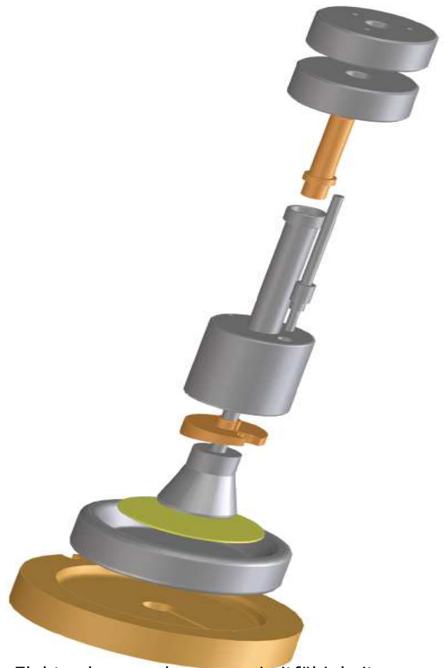
Prüfkessel zur Teilentladungs- und Leitfähigkeitsmessung Elektrodenanordnung zur Leitfähigkeitsmessung
